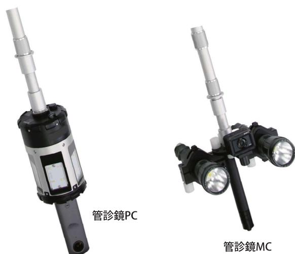
両製品とも地上作業のみで点検業務が完結するのがコンセプト。伸縮ポールは最大6mまで伸ばして使うことができる。入孔作業の際に必要であつた安全対策（硫化水素中毒・酸欠対策）を省略しつつ安全・効率的にスクリーニングが行える。維持管理会社はもとより、コンサルタントや自治体の購入も見越している。
