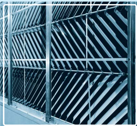
傾斜板沈降装置(横向流式)
