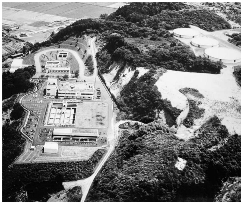
須江山浄水場の全景=中央部の既設沈澱池脇の空き地に40000m<sup>3</sup>/日を増設する。右側の一段高いところに既設の配水池
