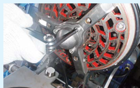
現場で短時間で消耗部品を交換可能
